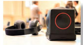
**Skoog** ist ein Würfel mit fünf Knöpfen in unterschiedlichen Farben. Er ist so programmiert, dass durch feines oder starkes Drücken der weichen Knöpfe Töne eines beliebigen Instruments erzeugt werden. Via App können Klänge, Tonleitern und Musikstücke frei gewählt werden.
