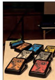
**Soundbeam** besteht aus zwei Elementen: dem Bewegungssensor, der einer Taschenlampe ähnelt, und den Pads. Jedes der bunten Pads erzeugt einen anderen Ton, eine Melodie oder ein Geräusch und kann individuell programmiert werden. Es wird durch kurzes oder langes Drücken und Antippen gespielt. Der Bewegungssensor indes funktioniert ohne Berührung. Die Klänge ertönen je nach Bewegung und Distanz zum Sensor.
